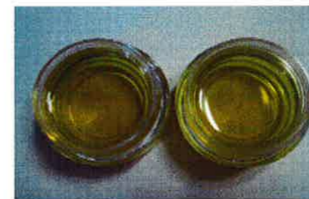
外観の色調(左が加速4ヶ月目、右は室温保存品、サンプル量は6g)
